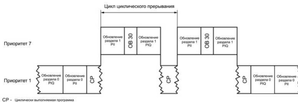
Рисунок 3-7 Интервал вызова циклического прерывания
